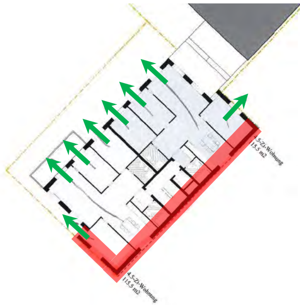
Abb. 10 Regelgeschoss B2; rote Bereiche: IGW-Überschreitungen an Fassade
