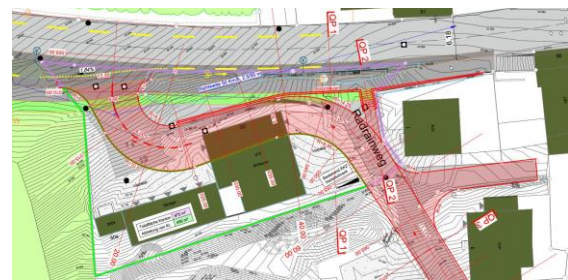
Radrainweg Anschlussvariante 1 (gebogene Verbindung)
