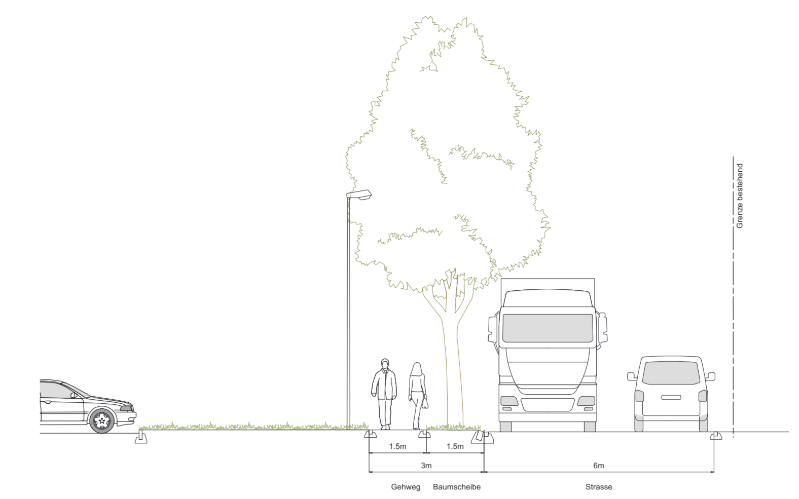
SCHMASCHNITT B-B, Mst. 1:100 Begegnungsfall LW/PW bei 40 km/h
